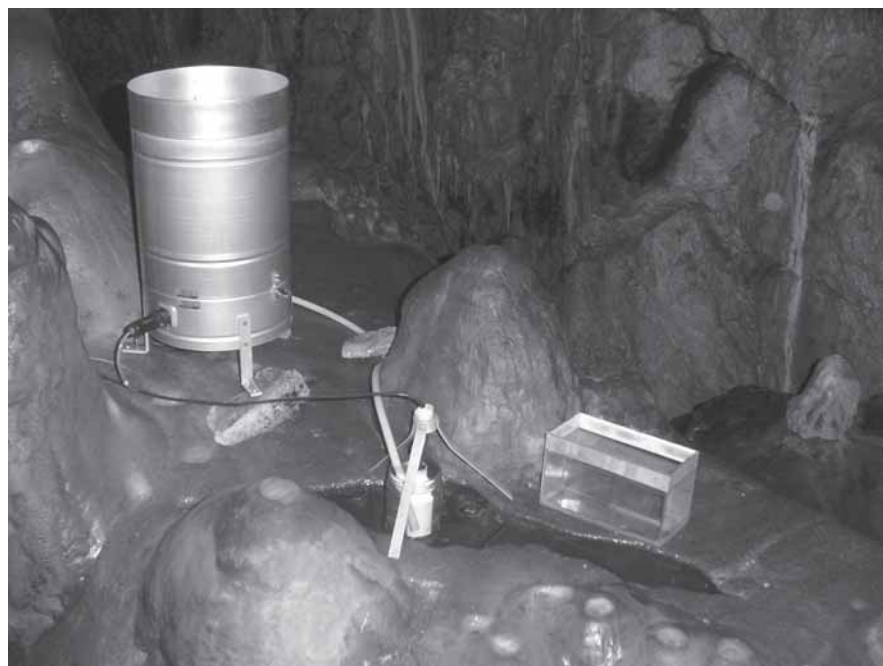
Fig. 1.- Control del goteo de estalactitas en la Cueva del Agua (Iznalloz, Granada).
